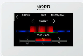
Індивідуальний графік роботи контуру опалення кухні з вимкненим режимом EcoMode
