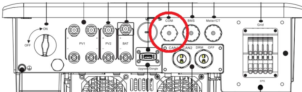
2. Schließen Sie nun das Datenkabel gemäß der Installationsanleitung an das NORD Power Genius 3000 an (direkte Verbindung A zu A, B zu B).
