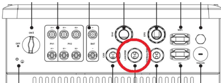
2. Schließen Sie nun den Konverter mit dem Datenkabel gemäß der Installationsanleitung an das NORD Power Genius 3000 an (direkte Verbindung A zu A, B zu B).
