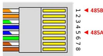
2. Schließen Sie nun das Datenkabel gemäß der Installationsanleitung an das NORD Power Genius 3000 an (direkte Verbindung A zu A, B zu B).
