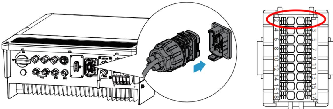
2. Der Wechselrichter verfügt nicht über einen integrierten Modbus-Kommunikationsabschluss. Auf der Wechselrichterseite wird empfohlen, einen Abschlusswiderstand zwischen den Klemmen 1 und 2 (A und B) anzuschließen - 120  $\Omega$  Widerstand, um eine zuverlässige Kommunikation zu gewährleisten.
