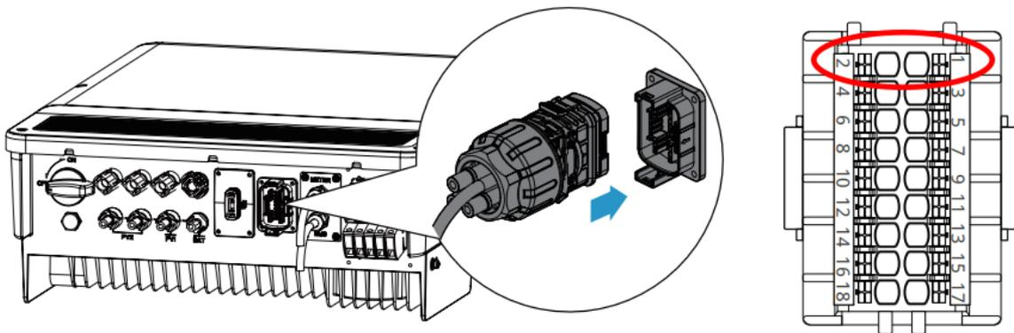
2. Der Wechselrichter verfügt nicht über einen integrierten Modbus-Kommunikationsabschluss. Es wird empfohlen, wechselrichterseitig einen Abschlusswiderstand zwischen den Klemmen 1 und 2 (A und B) anzuschließen - 120  $\Omega$  Widerstand, um eine zuverlässige Kommunikation zu gewährleisten.
