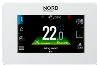
Úvodní obrazovka s detaily teplot zvolené místnosti
